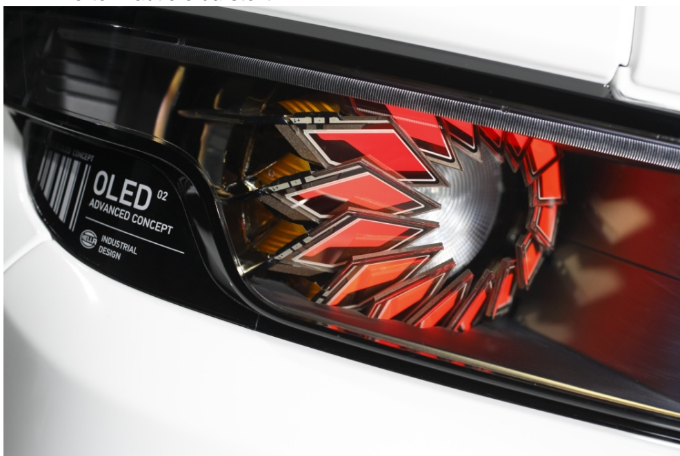
Bild 1: HELLA Auto-Heckleuchte mit 16 roten OLEDs
